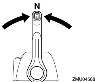
2. Relevez légèrement le moteur hors-bord jusqu'à la position voulue à l'aide de l'interrupteur de trim. **AVERTISSEMENT!** L'utilisation de l'interrupteur de trim du capot inférieur en cours de navigation ou lorsque le moteur tourne accroît le risque de passer par-dessus bord et peut distraire l'opérateur, augmentant ainsi le risque de collision avec un autre bateau ou un obstacle. [FWM01850]
