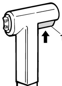
1. Commande de verrouillage de point mort
