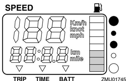
L'indication de niveau de carburant peut manquer de précision selon la position du capteur dans le réservoir de carburant et l'attitude du bateau sur l'eau. Si vous naviguez
