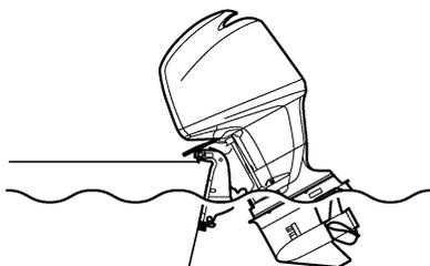
3. Pour ramener le moteur hors-bord à sa position de fonctionnement normale, appuyez sur l'interrupteur de trim et abaissez lentement le moteur hors-bord.
