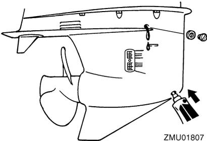
6. Placez un nouveau joint sur la vis de niveau d'huile. Lorsque l'huile commence à s'écouler par l'orifice de la vis de niveau d'huile, insérez et serrez la vis de niveau d'huile.
